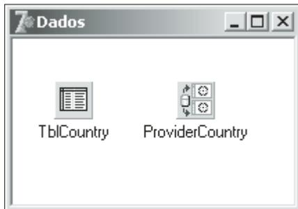
**Figura 35.2:** Aspecto do objeto RemoteDataModule – Objeto Dados, após a inclusão dos objetos Table e DatasetProvider.
